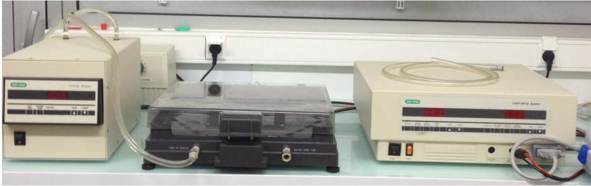
Figure 47 : Electro-phorèse CHEF-DR III Chiller System avec à gauche le système de refroidissement, au centre la cuve d'électrophorèse et à droite l'alimentation.
